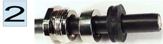
Schieben Sie Mutter, Druckring und Gummidichtung über das Kabelende. Tipp: Mit etwas Vaseline rutscht die Gummidichtung leichter über den Außenmantel.
