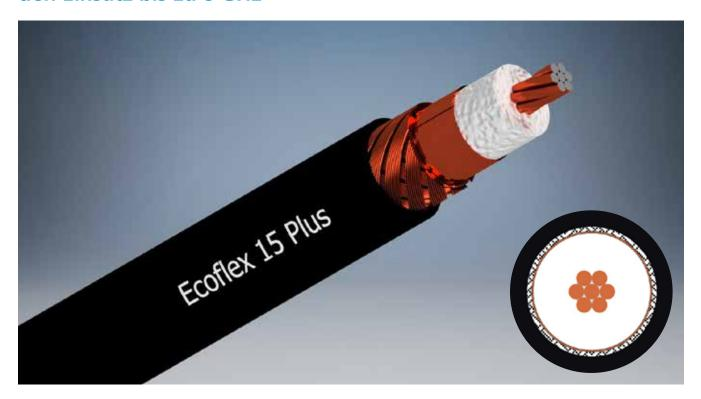
Ecoflex 15 Plus verfügt über bemerkenswerte elektrische und mechanische Verbesserungen. Der Aufbau und die Verwendung von Materialien sind optimiert auf geringste Dämpfung, eine um 2 GHz gesteigerte max. Frequenz, erstklassige Verlegeeigenschaften, hohe Langzeitstabilität und nicht zuletzt geringes Gewicht. Diese Kombination optimaler physikalischer Eigenschaften werden erreicht durch die Verwendung eines Präzisions-Hybrid-Innenleiters mit mikroverschweißtem Kupfermantel und Aluminiumkern.
